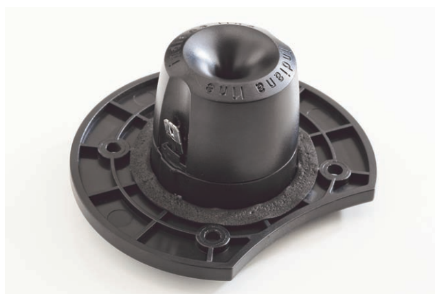
Il tweeter a cupola morbida ha la flangia frontale modellata per ravvicinare i centri di emissione. Il trattamento di irrigidimento della cupola è molto leggero ed il suono non aspro. Dietro la cupola è stata realizzata una cavità di decompressione dalla foggia particolare tesa a ridurre al minimo le colorazioni interne. Il magnete è in neodimio.
