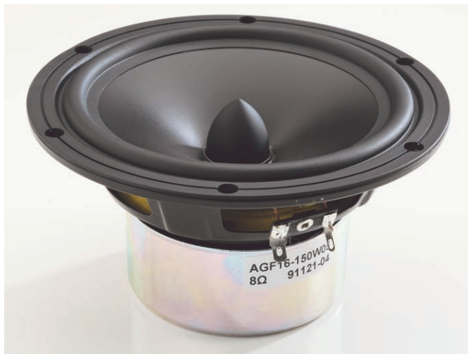
Uno dei due woofer utilizzati. Si tratta di un 165 mm con la membrana in polipropilene e mica. L'ogiva centrale è ricoperta di materiale gommoso.
