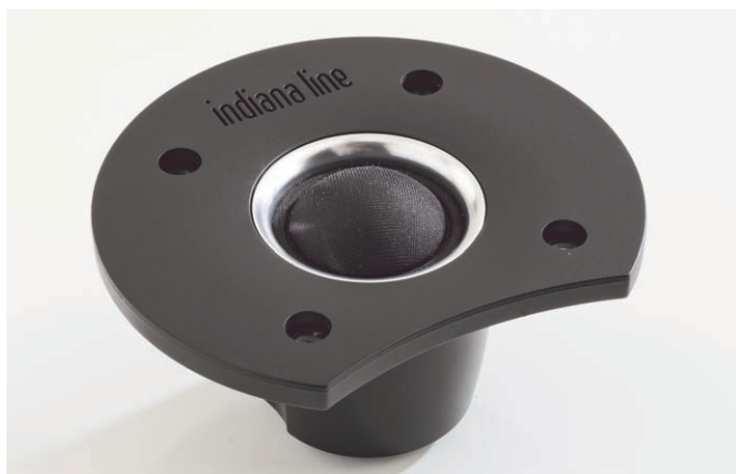
Il tweeter a cupola morbida ha la flangia frontale modellata per ravvicinare i centri di emissione. Il trattamento di irrigidimento della cupola è molto leggero ed il suono non aspro. Dietro la cupola è stata realizzata una cavità di decompressione dalla foggia particolare tesa a ridurre al minimo le colorazioni interne. Il magnete è in neodimio.
