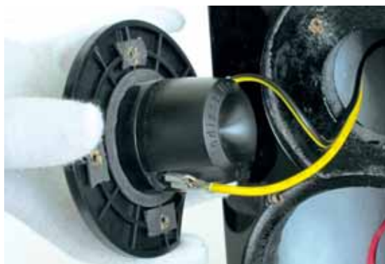
Particolare del woofer da 120 mm del tweeter da 26 mm di diametro.
