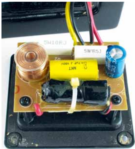
Particolare del crossover montato a ridosso della morsettiara.
